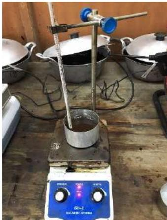
Gambar 2 Pencampuran Aspal dengan Glycerin Pitch
