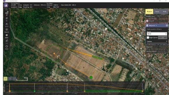
Gambar 7. Pembuatan *waypoint* pada aplikasi QGroundControl
