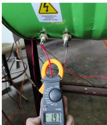
Gambar 17. Pengukuran Arus Pada Heater Menggunakan Clamp Meter
