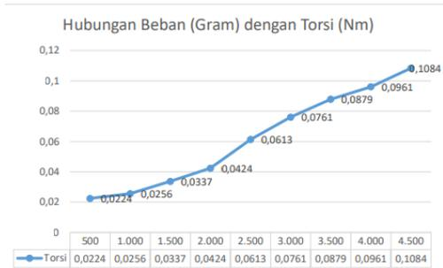
Gambar 9. Hubungan Beban dengan Torsi
