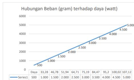
Gambar 10. Hubungan beban dengan daya
