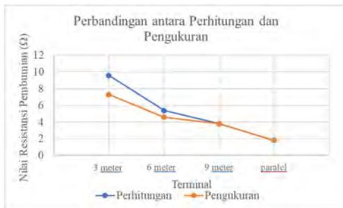
Gambar 12. Grafik Perbandingan antara Perhitungan dan Pengukuran
