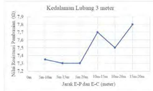
Gambar 8. Grafik Kedalaman Lubang 3 meter Gambar 8. menunjukkan data kedua dan ketiga didapatkan nilai pengukuran resistansi pembumian yang sama. Ada kenaikan nilai resistansi pembumian mulai dari data keempat sampai data keenam. Tetapi pada data kelima terdapat sedikit penurunan dikarenakan jarak E-P dan E-C yang cukup jauh yaitu dengan selisih 10 m.
