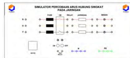
Gambar 7. Perancangan layout pemutus CB simulator jaringan SUTM
