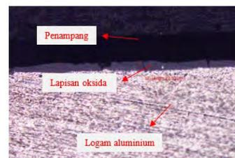
Gambar 5. Lapisan oksida hasil *hard anodizing*
