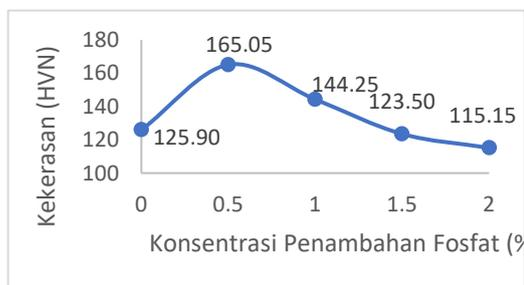
**Gambar 7.** Hubungan penambahan konsentrasi fosfat terhadap kekerasan permukaan logam
