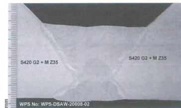
Gambar 11: Sketsa dari Pengujian *Macro Test*
