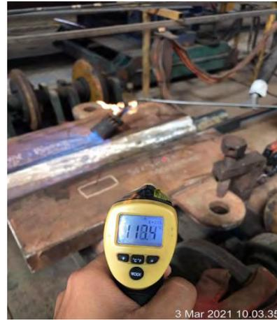
Gambar 3: *Preheat Temperature* Sebelum Melakukan Pengelasan
