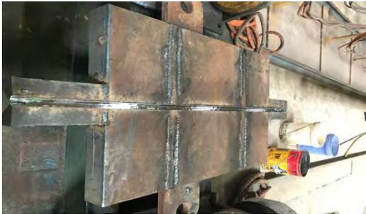
Gambar 13: Hasil *Back weld* dengan *Miling Machine*
