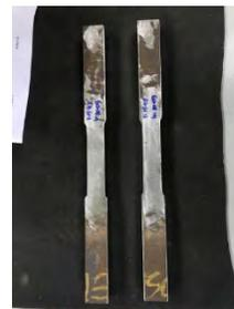
Gambar 7: *Spesimen Tensile Test (Transverse)*
