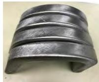
Gambar 21: Hasil Spesimen *Bending Test*
