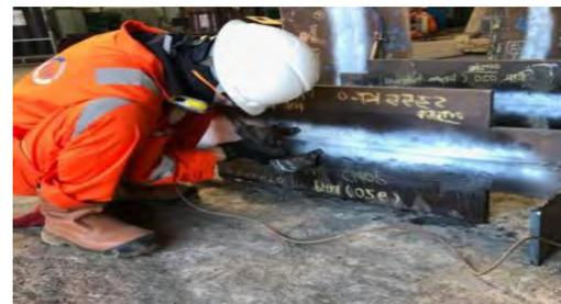
Gambar 19: Hasil Pengujian MPT (*main*) *outside*
