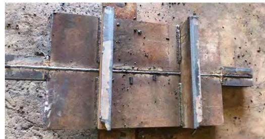
Gambar 12: Hasil Pengelasan *seal weld*
