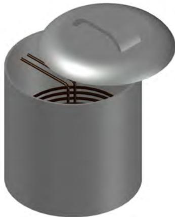
Gambar 2. Kontruksi Water Tank
