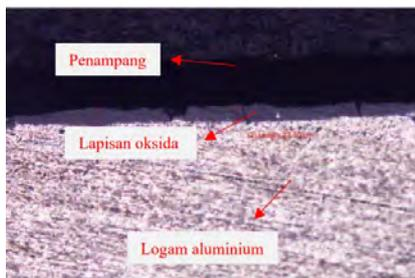
**Gambar 4. 1** Lapisan Oksida Hasil *Hard anodizing*
