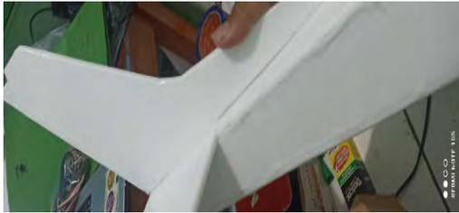
Gambar 6 Pemasangan Horizontal Stabilizer
