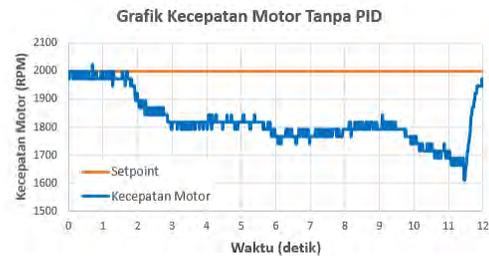
Gambar 8. Grafik respon kecepatan motor tanpa PID
