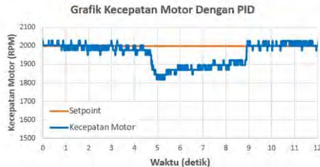
Gambar 9. Grafik respon kecepatan motor dengan PID
