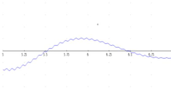
Gambar 9. Grafik Simpangan terhadap Waktu untuk Osilasi Paksa Teredam Sistem Pegas dengan Beban Bermassa tidak Konstan dalam Kondisi Tunak
