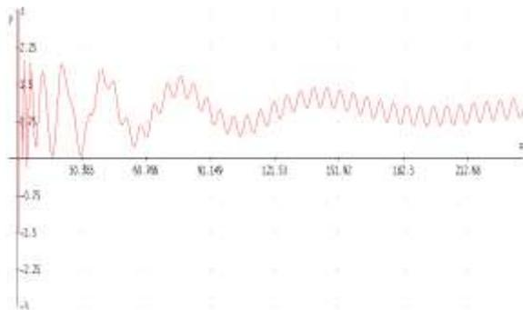
Gambar 8. Grafik Simpangan terhadap Waktu untuk Osilasi Paksa Teredam Sistem Pegas dengan Beban Bermassa tidak Konstan dalam Kondisi Mendekati Tunak
