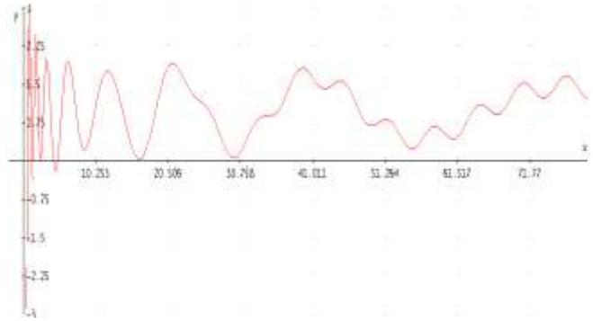
Gambar 7. Grafik Simpangan terhadap Waktu untuk Osilasi Paksa Teredam Sistem Pegas dengan Beban Bermassa tidak Konstan dalam Kondisi Sesaat setelah *crash*
