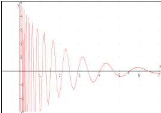
Gambar 6. Grafik Simpangan terhadap Waktu untuk Osilasi Paksa Teredam Sistem Pegas dengan Beban Bermassa tidak Konstan
