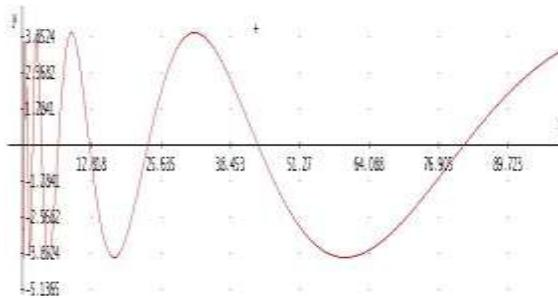
Gambar 5. Grafik Simpangan terhadap Waktu untuk Osilasi Bebas dengan Massa yang Berubah Linier terhadap Waktu
