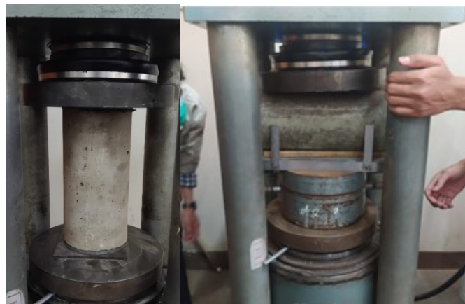
(a) (b) Gambar 1. Pengujian: a) kuat tekan beton, b) kuat tarik beton
