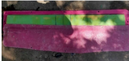
Gambar 6 Cetakan bagian wing dari pesawat
