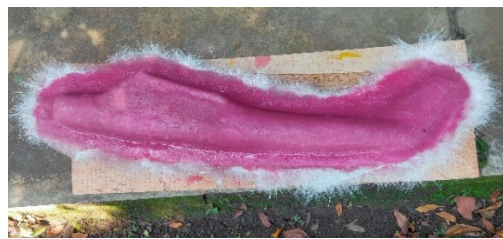
Gambar 8 Cetakan bagian fuselage dari pesawat
