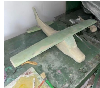
Gambar 5 pembuatan mock up model pesawat cessna 172N
