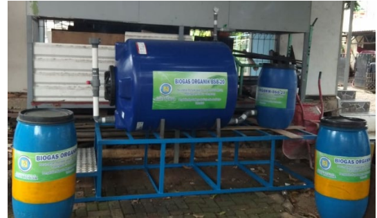
Gambar 1. Rancangan dan realisasi biodigester sampah organic skala kecil
