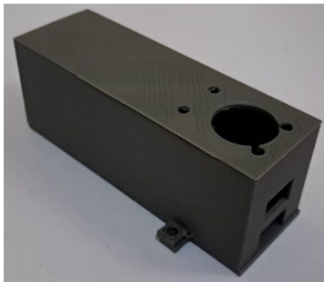
Gambar 8. Casing hasil pencetakan 3D
