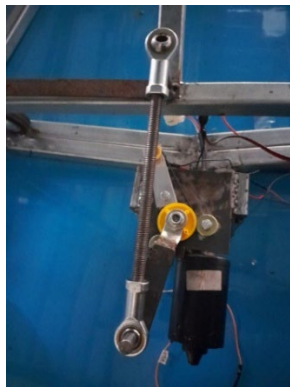
Gambar 3. Posisi tanduk motor wiper 3
