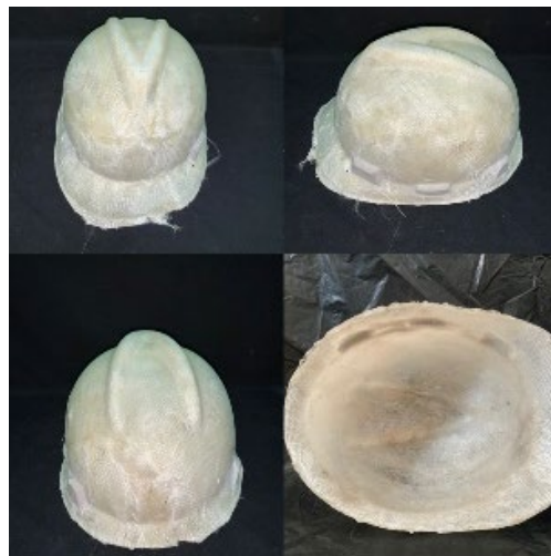
Gambar 9. Kerusakan manufaktur industrial safety helmet komposit GFRP dengan resin poliester
