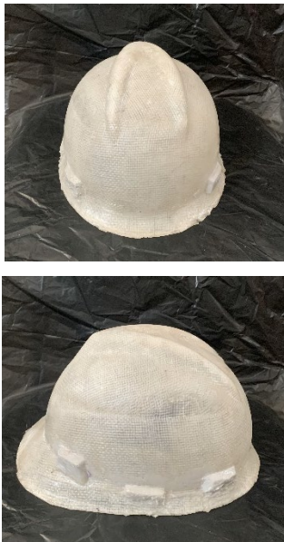
Gambar 8. Industrial safety helmet komposit GFRP dengan resin poliester
