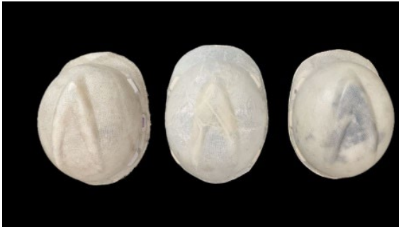
Gambar 7. Hasil manufaktur helm keselamatan komposit GFRP
