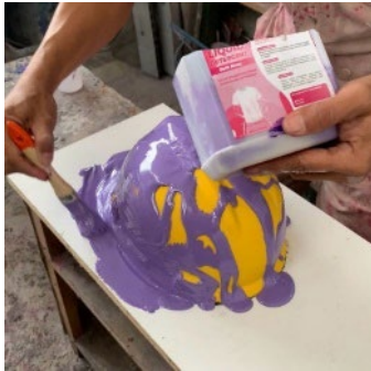
Gambar 3. Proses manufaktur pembuatan molding industrial safety helmet
