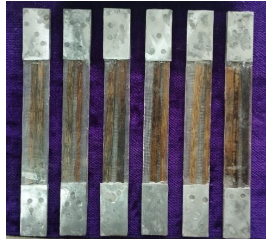
Gambar 5. Spesimen pelepah pohon lontar dengan fiberglass
