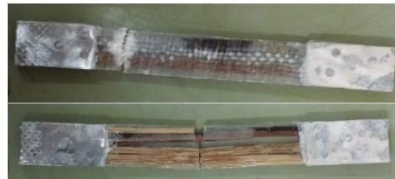
Gambar 7. Spesimen setelah uji tarik
