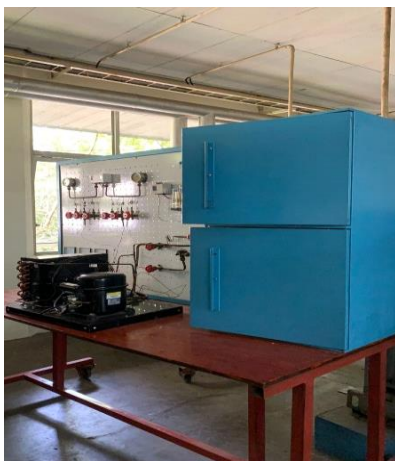
Gambar 3. Unit Instalasi Sistem Refrigerasi
