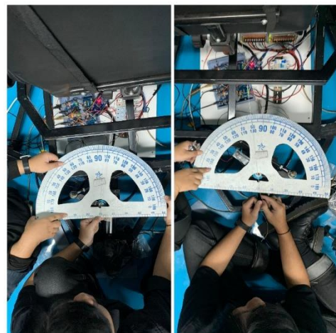
Gambar 11 Pengukuran menggunakan busur ketika platform yawing +10^\circ dan -10^\circ
