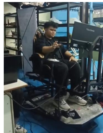
Gambar 14 Platform dalam posisi Rolling -10°
