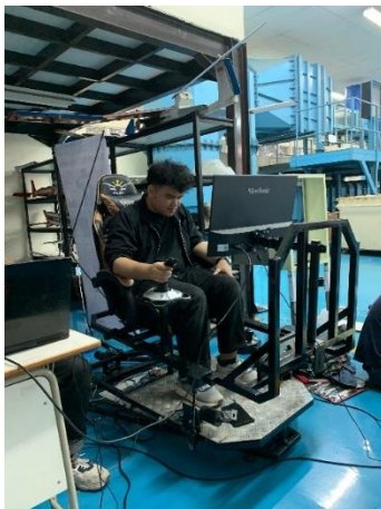
Gambar 12 Platform pada posisi pitch -5°
