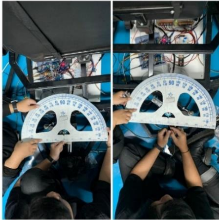
Gambar 15 Pengukuran menggunakan busur ketika platform yawing +10^\circ dan -10^\circ
