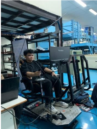
Gambar 11 Platform pada posisi pitch +10°
