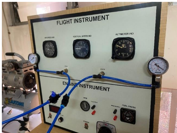
Gambar 6. Hasil Instalasi Sistem Kontrol Manual dan Indikator
