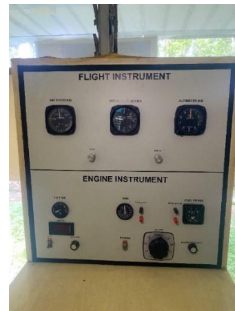
Gambar 2. Kondisi Pitot-Static Tester Sebelum di Tingkatkan
