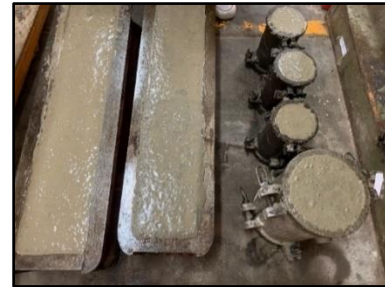
Gambar 4 Beton Segar pada Cetakan Balok dan Silinder
