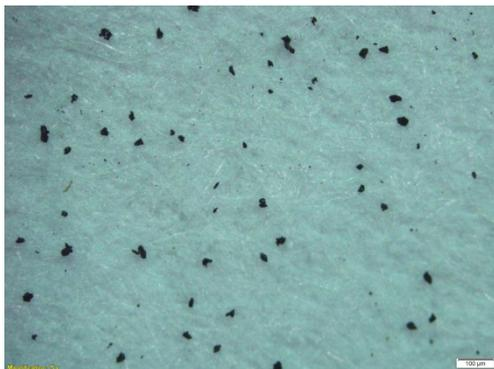
Gambar 2 Ukuran partikel setelah grinding berkisar 2 – 5  $\mu\text{m}$
