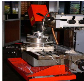
Gambar 1. Penggunaan *Cutting Fluid/Coolant* pada Proses Milling [2]
