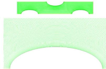
Gambar 4. Mesh segitiga dan quad untuk aliran diatas tabung eliptik [4]
