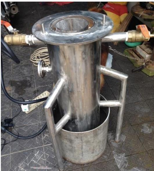
**Gambar 2. Bentuk Final Reaktor Gasifikasi**
