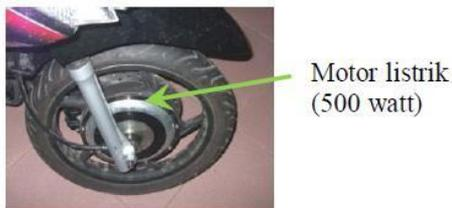
Gambar 1. Pemasangan motor listrik
