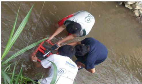
Gambar 9. Proses menghitung kecepatan sudut dengan Tachometer
