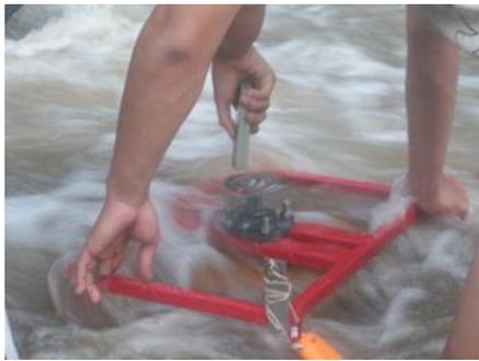
Gambar 10. Proses pengukuran kecepatan putar TASV
