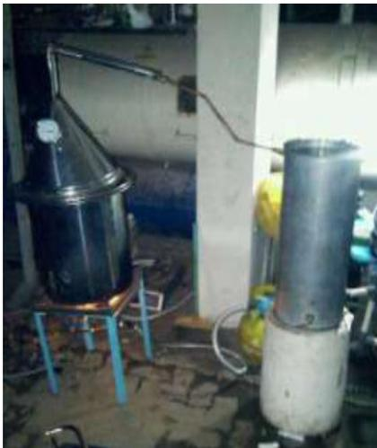
Gambar 2: Sistem Pirolisis sederhana dengan redestilator.
