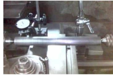
Gambar 2: Pengukuran kelurusan bahan uji
