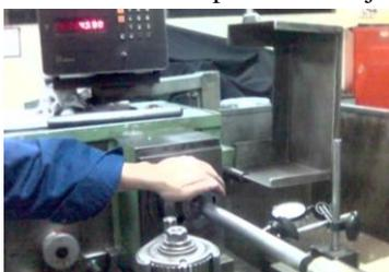
Gambar 1: Posisi jarum dial indikator pada pertengahan arah horisontal dan vertikal bahan uji
