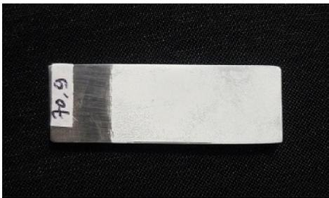
Gambar 5. Plat yang telah dilapisi TiO<sub>2</sub> (tegangan 90 Volt, waktu deposisi 9 menit)
