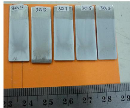
Gambar 2. Plat yang telah dilapisi TiO<sub>2</sub> dengan tegangan 30 Volt (dari kiri ke kanan waktu elektroforesis: 11 menit, 9 menit, 7 menit, 5 menit dan 3 menit)
