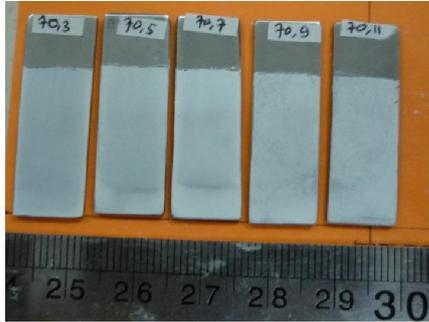
Gambar 4. Plat yang telah dilapisi TiO<sub>2</sub> dengan tegangan 70 Volt (dari kiri ke kanan waktu elektroforesis: 3 menit, 5 menit, 7 menit, 9 menit dan 11 menit)
