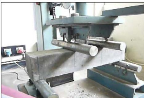
Gambar 3.4. Pengujian Kuat Lentur Beton
