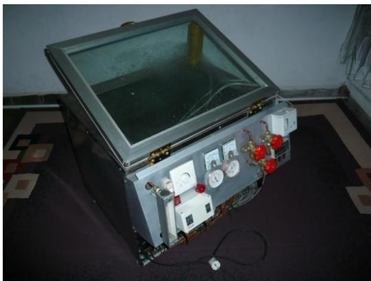
Gambar 3.13 *mini freezer* yang dilengkapi fluida penyimpan dingin setelah selesai dibuat
