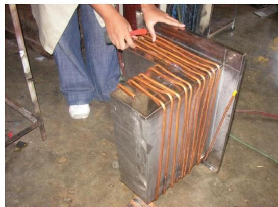
Gambar 3.10 Pembuatan kabin bagian dalam mini freezer
