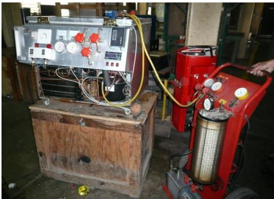
Gambar 3.12 Proses uji coba *mini freezer* yang dilengkapi dengan fluida penyimpan dingin
