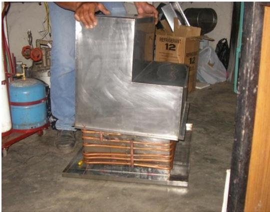
Gambar 3.11 Pemasangan tangki penampung fluida penyimpan dingin *mini freezer*
