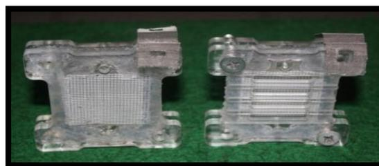
Gambar 11. HFC 3 x 3 cm Sisi Anoda (kiri) dan Sisi Katoda (kanan)
