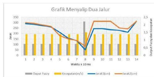
Gambar 9: Data percobaan pada jalan dua lajur
