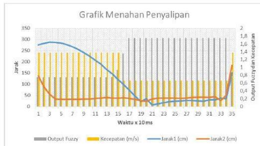
Gambar 10: Data percobaan penyalipan tertunda
