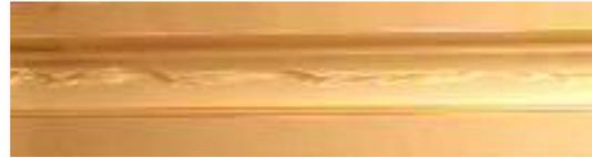
Gambar 3b: *Wavy flow* pada pipa horizontal ( $J_L=0.012$  m/s,  $J_G=2.31$  m/s)
