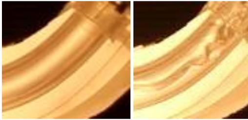
Gambar 5a: *Stratified flow* pada pipa miring ( $J_L=0.012\text{ m/s}$ ,  $J_G=0.66\text{ m/s}$ )
