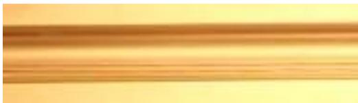
Gambar 3a: *Stratified flow* pada pipa horizontal ( $J_L=0.012$  m/s,  $J_G=0.66$  m/s)
