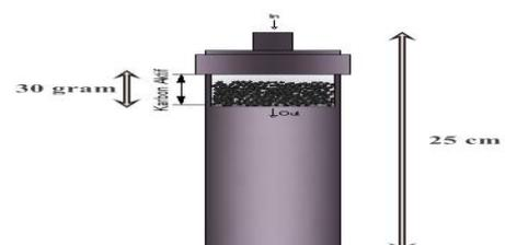
Gambar. 1 Pengolahan air minum *portable* dengan media filter karbon aktif
