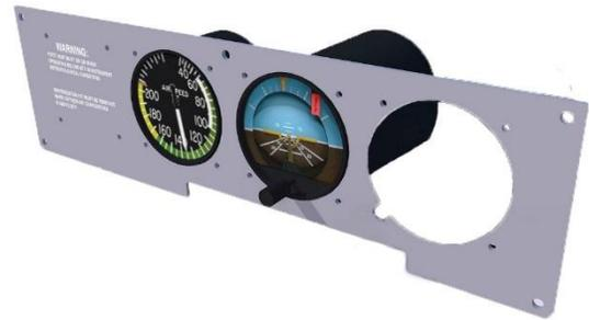
Gambar 4. Desain Mekanik dari Airspeed dan Attitude Indicator
