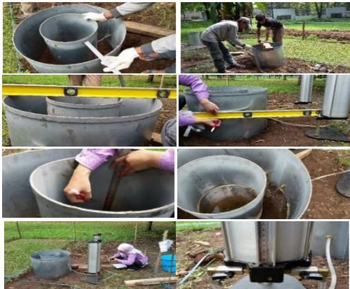
Gambar 5. Pengujian Infiltrasi di Lapangan
