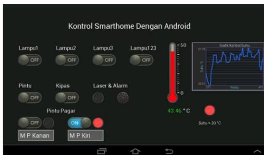
Gambar 21. Kontrol Pintu Pagar Motor Putar kiri
